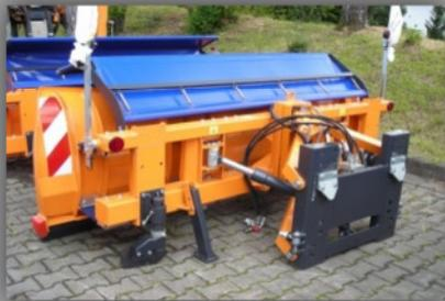
Überfahrtsicherung durch vorgespannte elastische Schwinglenker mit ausgezeichneten Dämpfungseigenschaften
