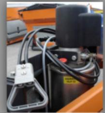
Elektrohdraulisches Aggregat (Option)
