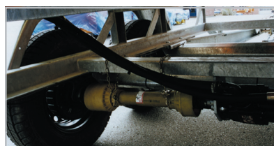
Radpumpe auf dem Trailerchassis montiert (option).
