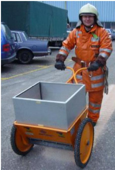
Durch das EpoOel Dosierprinzip wird eine gleichmäßige und sparsame Verteilung des Streumaterials erreicht.
