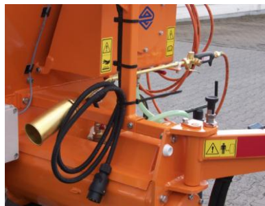
Brenner zur Schlaglochvorbereitung
