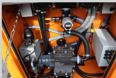
Ein leicht zugänglicher Maschinenraum schützt Hydraulik, Steuerung und Membranpumpe
