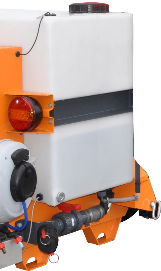
kuppeln und damit ein präzises Streubild sicherstellen. Der VIRTUS BASIC ist für kleinere Trägerfahrzeuge mit 3-Punkt-Aufhängung ausgelegt. Die Maschine wird über die Hydraulikanlage des Trägerfahrzeugs oder eine Zapfwellenpumpe angetrieben. Das Tachosignal des Trägerfahrzeugs sorgt für eine geschwindigkeitsabhängige Soledosierung. Der Sprühbalken wird mittels der Aufhängung des Trägerfahrzeugs in der Höhe verstellt. Die ausgebrachte Sole wird auf der Fahrbahn aus niedriger Höhe dosiert.
