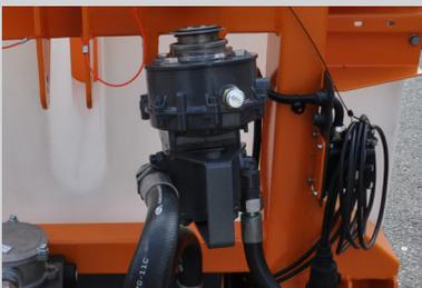
Zapfwellenbetrieb mit einer am Streuer montierten Hydraulikpumpe
