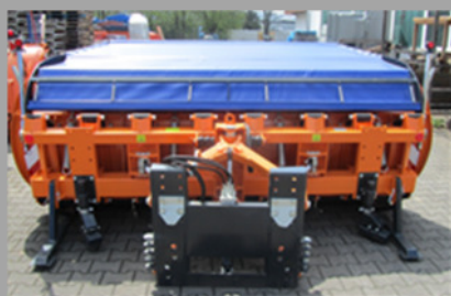
Überfahrtsicherung durch stabil geführte Stahllenker mit ausgezeichneten Dämpfungseigenschaften und Rückholfeder
