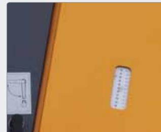
Elektronischer Flüssigkeitsanzeiger ist Standard. Der Flüssigkeitsstand ist mittels Dioden von 0-100% ablesbar.
