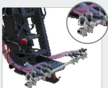
Hochgeschwindigkeitsstreuung mit Spratronic-Düsen. Effiziente Streuung bei Geschwindigkeiten bis zu 90 km/h.
