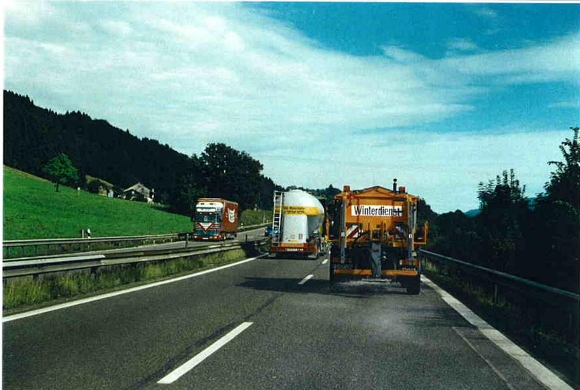
Ausbringung trocken, bei ca. 50 km/h, 6m Streubreite, Streubild ca. 1m nach links verschoben
