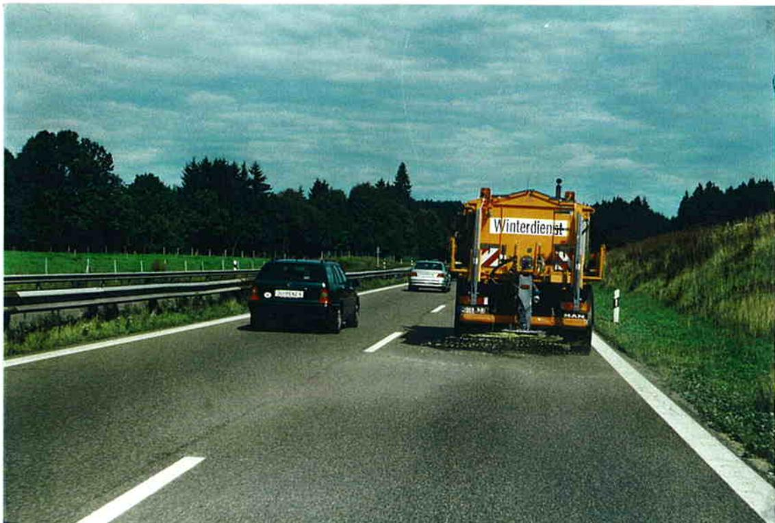
Ausbringung mit 30% Soleanteil (FS30), bei ca. 50 km/h, 6m Streubreite, Streubild ca. 1m nach links verschoben
