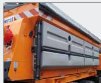
Seitentanks mit bis zu 3500L Sole, die mit der Außenkontur des Streuautomaten abschließen.
