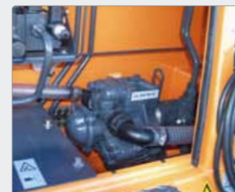
Wartungsfreundlich aufgebautes Flüssigkeitssystem, mit leistungsstarker Kolbenmembranpumpe
