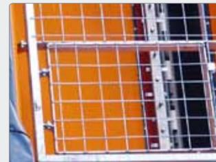
Der Gitterrost hat eine Inspektionstür für schnellen Zugang zum Behälter.
