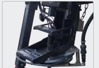
Die breiten Stufen an der Aufstiegsleiter ermöglichen einen sicheren Zugang zum Maschinenraum.
