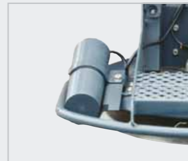
EpoTector - die berührungslose, elektronische Streukontrolle von Epoke® A/S patentiert.
