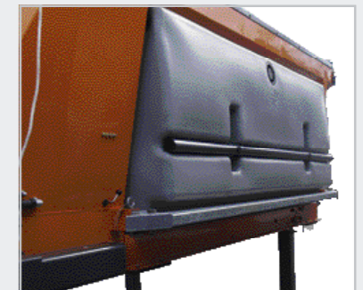
Soletanks vom Spezialdesign für gleichmäßige Füllung/Entleerung.
