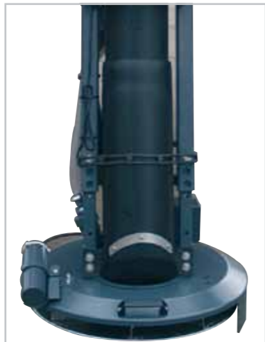
Streustoffverteiler mit Mischkammer auf dem Streuteller
