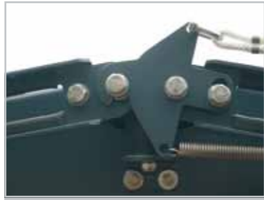
Klappdachverriegelung verhindert das Öffnen bei starkem Fahrtwind
