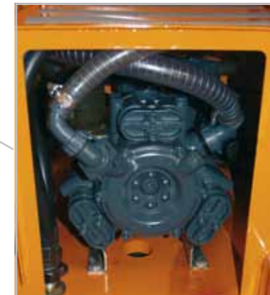
Kolbenmembranpumpe – wartungsarm, Befeuchtungsgrad einstellbar
