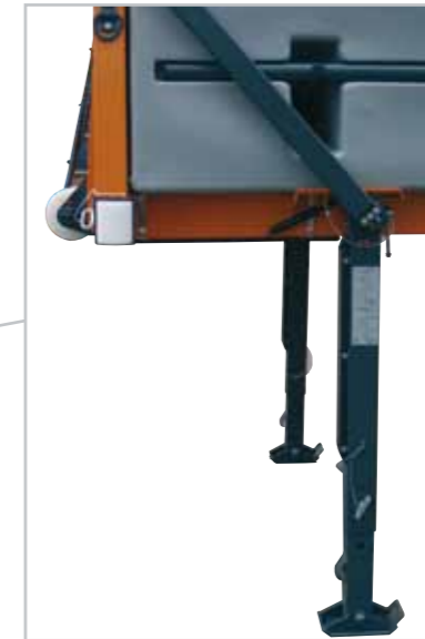
„Feste Rolle“ – Schnellabsetzvorrichtung bis 14 Tonnen.
